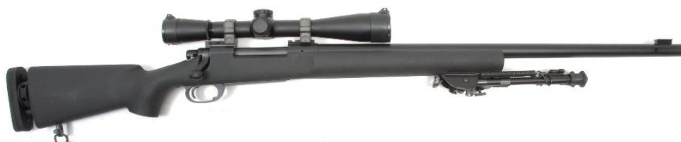
Fusil M – 24 SWS (Sniper Weapon System) Fusil de cerrojo Remington 700, de fabricación estadounidense.
